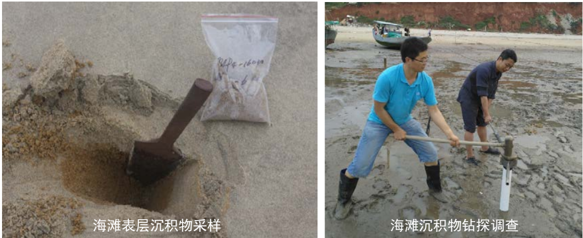
图 2 海滩表层沉积物和柱状样采集（图片来源：自然资源部第三海洋研究所）
