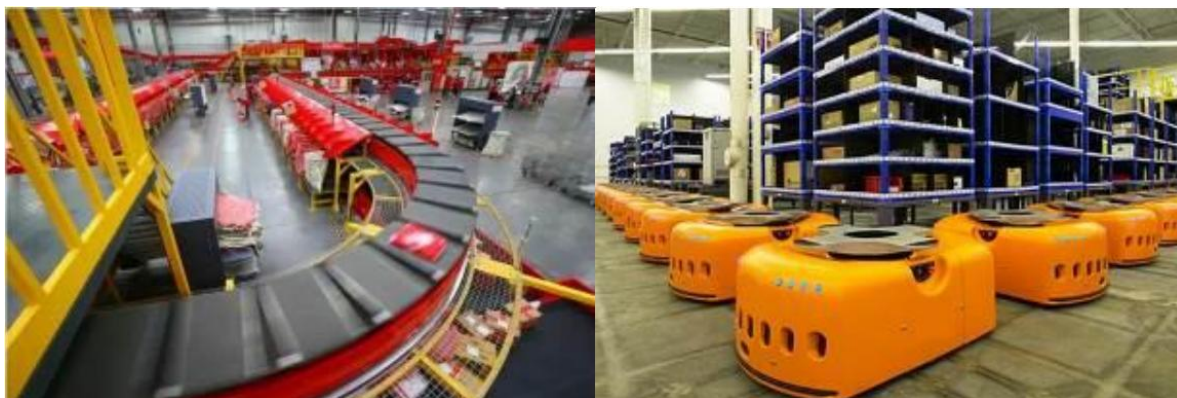
图 4-7 自动分拣运输系统图
