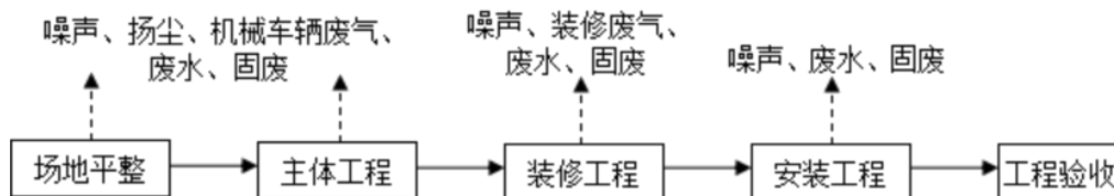
图 2.3-1 施工期工艺流程及产污环节示意图
