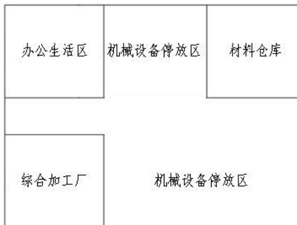
图 1 施工临时场地平面示意图
